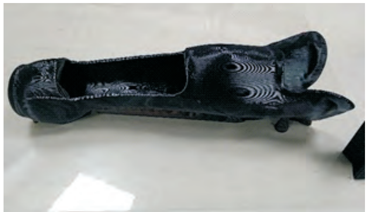
कृत्रिम अंग के लिए सिरोप्लांगकी सॉकेट का प्रोटोटाइप – मैसर्स एएलटीईएम टेक्नोलॉजीज
